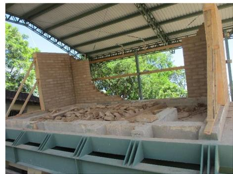
写真4 アドベ壁の傾斜台試験(UES)
