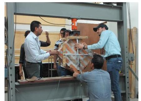
写真3 レンガ壁直接せん断試験(UES)
