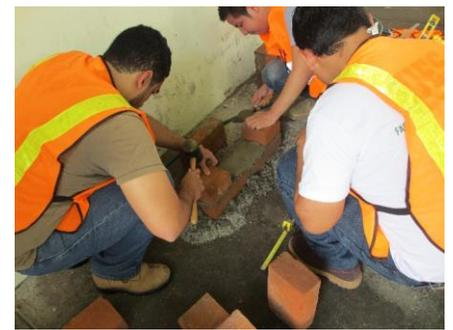
写真2 煉瓦プリズム試験体作成(UES)
